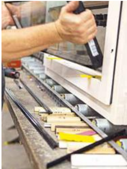
2. Schritt: Setzen Sie die Glasscheibe entsprechend den Richtlinien in den Rahmen.
