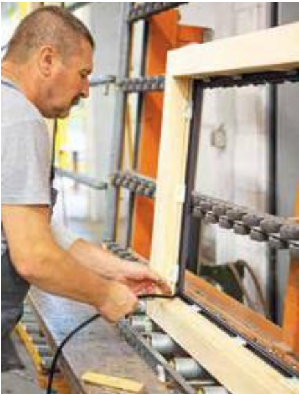
1. Schritt: Legen Sie die Trockendichtung für die Außenseite in den Rahmen ein.
