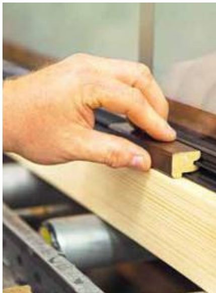
5. Schritt: Legen Sie die Fixclip-Schiene ein und pressen Sie sie mit der Schablone an.
