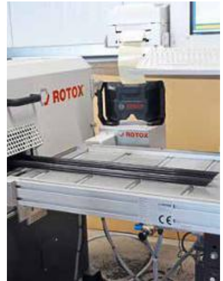
3. Schritt: Schneiden Sie die Fixclip-Schiene passend zu, z.B. mit einer Kappsäge.
