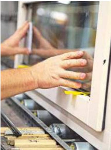
4. Schritt: Drücken Sie die Glasscheibe an die Trockendichtung an.
