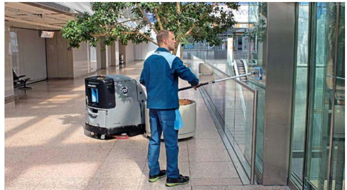
Hindernisse erkennt die Maschine mittels ihrer Sonarsensoren und umfährt sie.
