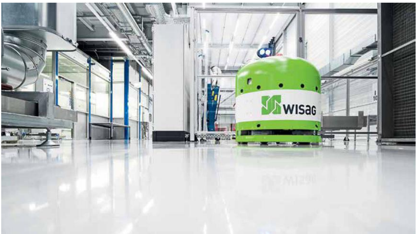
Der scherzhaft „W2D2“ genannte Cleanfix-Reinigungsroboter von Wisag im Einsatz in der Lackieranlage von BMW in München.
