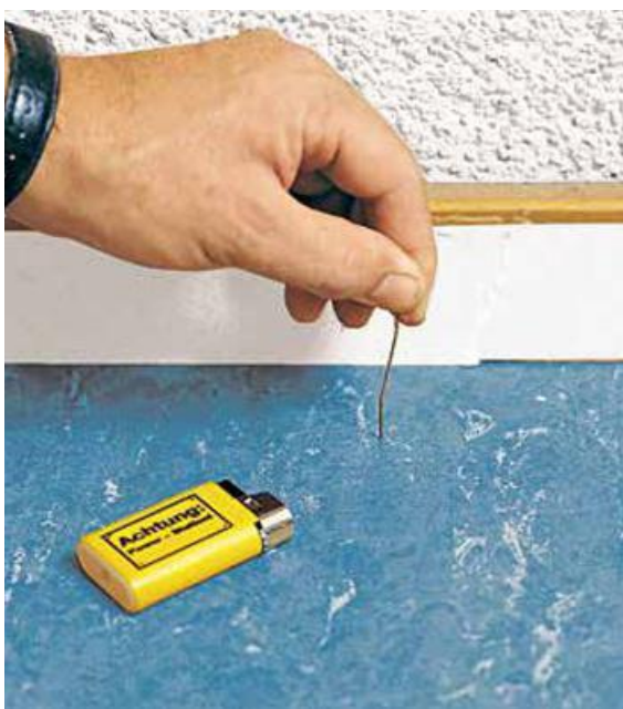
Zur Unterscheidung von PVC/Vinyl, Elastomer und Linoleum bietet der Büroklammertest eine schnelle Hilfe.
