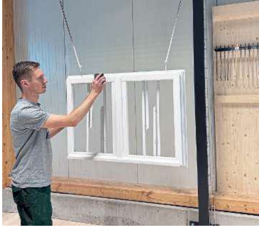
Der Zwischenschliff erfolgt am hängenden Teil – einmal in die Traversen eingehängt, müssen die Fenster nicht mehr manipuliert werden.
