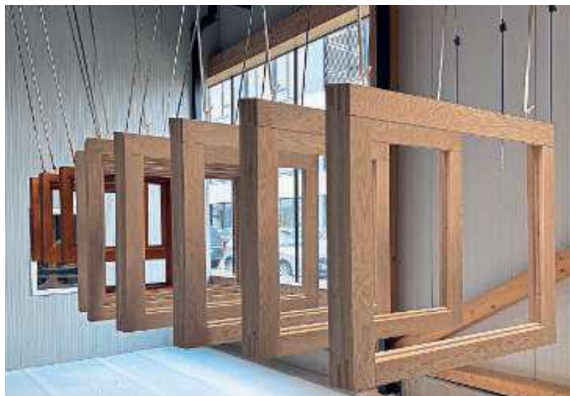
Bei entsprechender Planung ist die Fensterbeschichtung innerhalb eines Tages erledigt.
