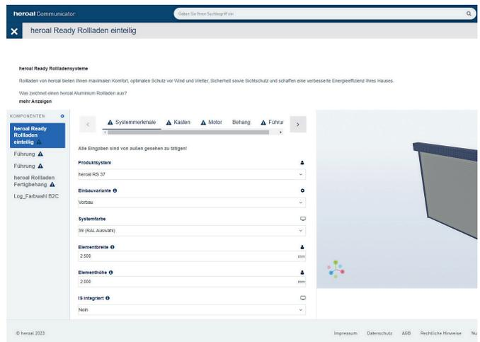
**5. Schritt:** Die vom Endkunden im Rollladen-Konfigurator eingegebenen Angaben werden direkt in den Heroal Konfigurator übernommen. Sie werden nun durch die Konfiguration geführt und können Eingaben ergänzen oder anpassen. Eine Plausibilitätsprüfung stellt sicher, dass sich nur technisch machbare Konfigurationen eingeben lassen.
