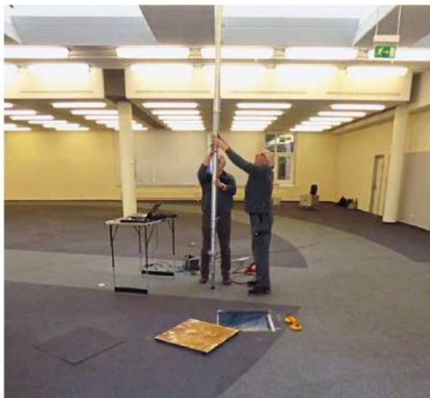
Belastungsprüfung an einer Hohlbodenfläche mit Prüfgestänge.
