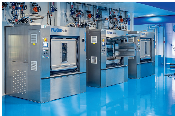
Trennwandwaschmaschinen verhindern eine Rückkontamination zwischen unreiner und reiner Seite.
