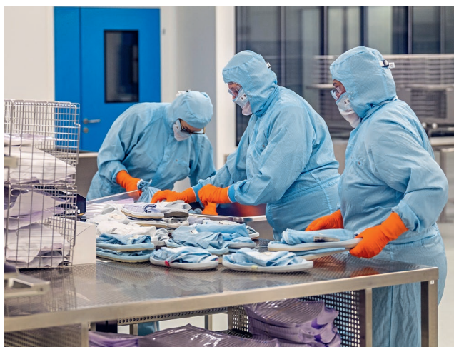
Arbeit im Reinraum: Mitarbeitende tragen Vollschutzkleidung, um Partikel- und Keimeinträge zu vermeiden.
