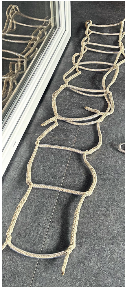
2. Schritt: Schlagen Sie das Tragenetz um, um es an die Breite des Flügels anzupassen.
