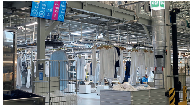
Automatisch ans Ziel: Die Anlage sortiert Textilien auftrags- und tourengenau – ohne manuelles Eingreifen.
