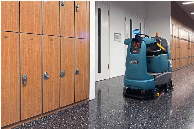
OBEN: Die Tennant T7AMR im Einsatz. Sie verfügt, wie die kleinere Maschine auch, über die ec-H<sub>2</sub>O-Technologie, die das Wasser elektrisch aktiviert, sodass eine Reinigungslösung entsteht, die effektiv auch ohne Chemie reinigt.
