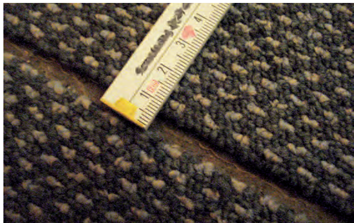
Abb. 44: Fugenbildung im textilen Bodenbelag aufgrund nicht ausreichenden Klebstoffauftrages sowie Einsatz ungeeigneter Werkzeuge
