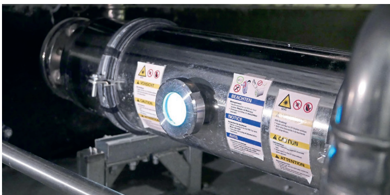
In dem Reaktor des von CHT Beitlich patentierten „Smart UV Power“-Systems verstärkt UV-C Licht die Bildung von Wasserstoffperoxid im Klarwaschwasser.
