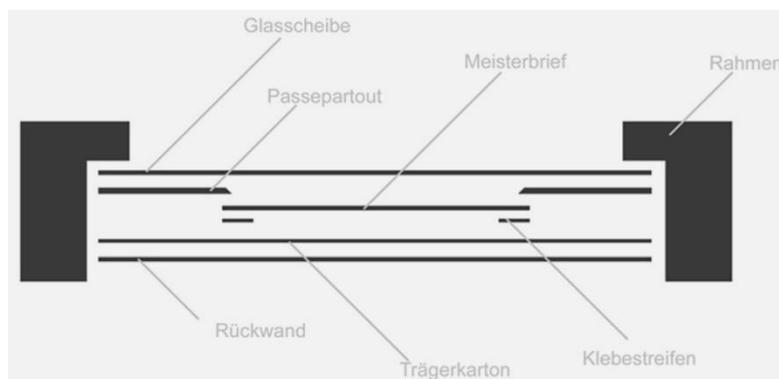
Abb. 2: Querschnittzeichnung vom Aufbau einer Rahmung mit Passepartout.
