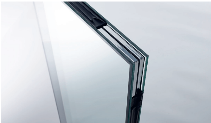
Skinny Triples: Dreifach-Isolierglas mit Dünnglasscheibe in der Mitte. Als Abstandhaltersystem kommt Super Spacer zum Einsatz.
