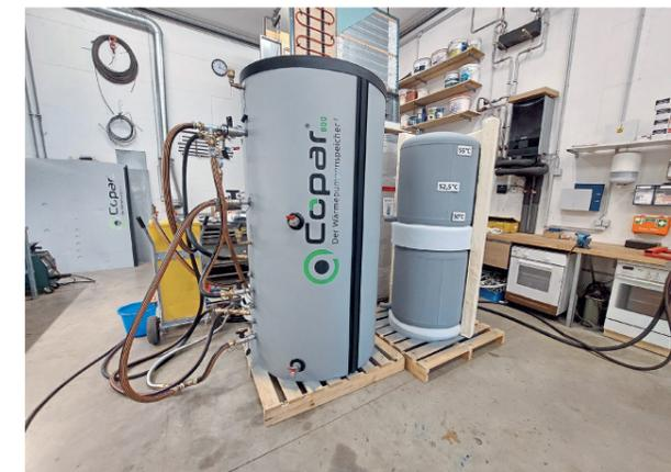
Testaufbau zur Schüttleistung mit einem modifizierten Copar-Wärmespeicher.
