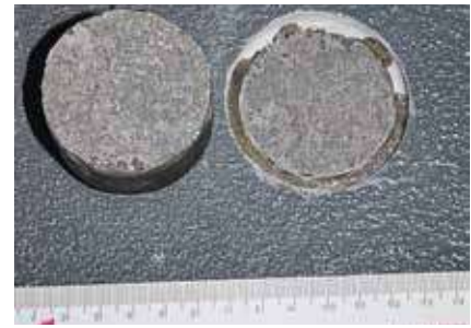
Zu geringe Haftfestigkeit einer Bodenbeschichtung: statt mind. 1,50 N/mm 2 nur > 0,86 N/mm 2 bis < 1,25 N/mm 2 .
