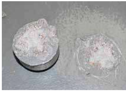
... und Stempelhaftzugprüfung mit 0,54 N/mm 2 Haftfestigkeit.
