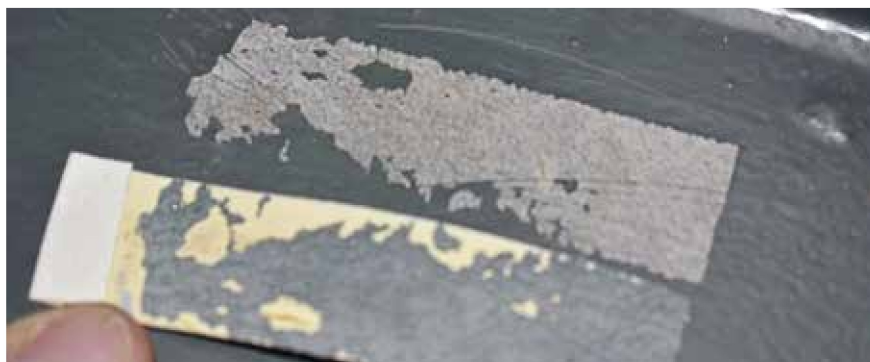
Pigmentierte Versiegelung: Ungenügende Haftfestigkeit nach Tape-Test...
