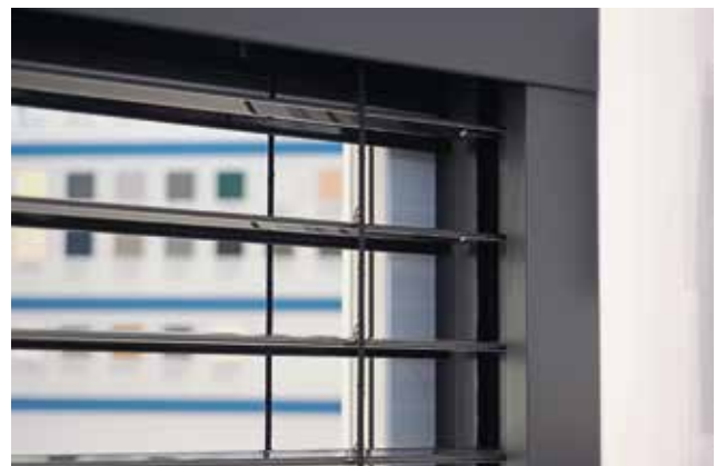
Um den seitlichen Lichteinfall zu reduzieren, kommen bei LS Dark spezielle Bürsteneinlagen in den Führungsschienen zum Einsatz. Aluminium-Abdeckbleche runden das Verdunklungssystem ab.
