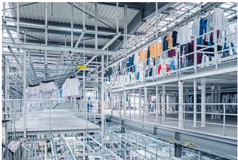
Berufsbekleidung wird automatisch und personenbezogen sortiert.
