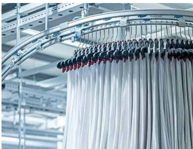
Die Textilien bewegen sich automatisiert von einer Station zur nächsten.
