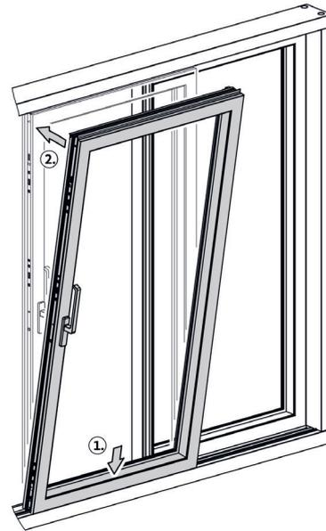
**2. Schritt:** Positionieren Sie den Flügel auf der unteren Laufschiene und schwenken Sie ihn senkrecht ein. Wichtig: Der Handgriff muss beim Einschwenken des Flügels nach oben gedreht sein, der Flügel befindet sich so im abgesenkten Zustand.
