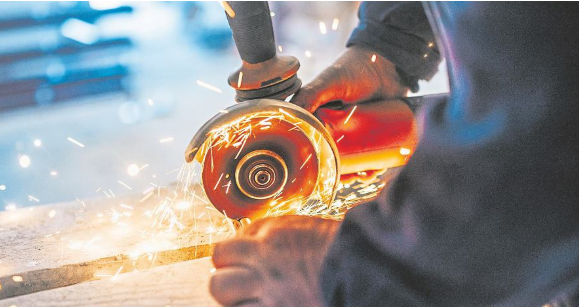
Alles falsch gemacht: Nur eine Hand am Gerät, die andere hält das Werkstück – Tausende verletzen sich jedes Jahr mit solch einer Arbeitsweise.
