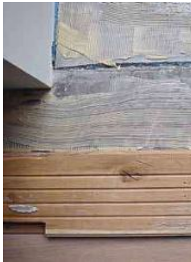
Hier war fast keine Benetzung mit Klebstoff vorhanden.
