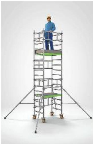
**Ein-Personen-Gerüste:** Mobile Ein-Personen-Gerüste sind leicht zu transportieren und gewährleisten einen sicheren Standplatz für Tätigkeiten in bis zu sechs Meter Arbeitshöhe. Die Gerüste lassen sich von einer Person ohne Werkzeug aufbauen und dank ihrer kompakten Maße (circa 1,2 Meter x 0,8 Meter) zum und vom Einsatzort in normalen Nutzfahrzeugen bequem befördern.
