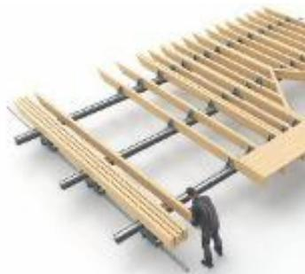
**Montage-Tische** Die unter anderem für das Vorfertigen von Wand-, Decken- oder Dachelementen im Holzbau zum Einsatz kommenden Montagetische erlauben eine sichere, meist sogar schnellere und vor allem witterungsunabhängige Vormontage in der Werkstatt oder direkt auf der Baustelle. Je nach System können dabei Bauteilgrößen von circa 3,50 x 12 Meter erreicht werden.
