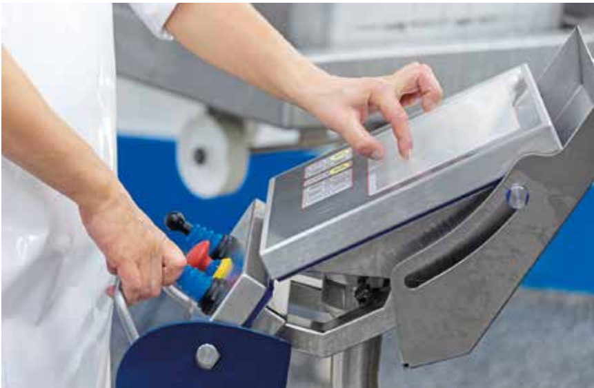
Das Touchpanel ist ein für Lowis maßgeschneidertes Bedienfeld für die Funktionen, die der Betrieb täglich braucht, wie Messergeschwindigkeit, Vakuum, Temperatur oder Schüsseldrehzahl.
