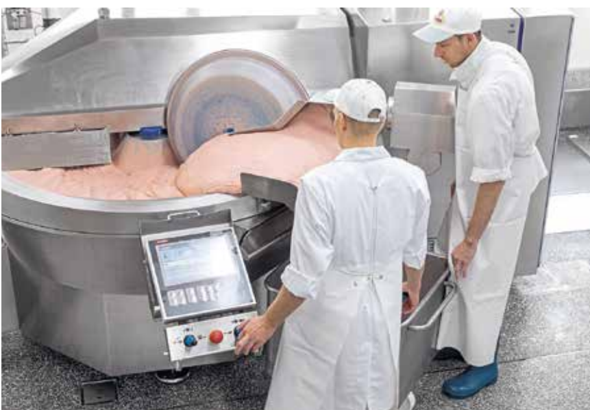
Die Konstruktion des VCM 360 erlaubt eine optimale Ausnutzung des Schüsselvolumens – für große Chargen in bester Qualität und ohne Verluste durch Überlaufen.
