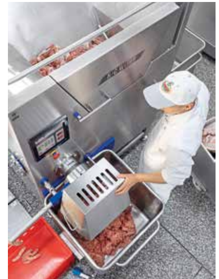
Unerwünschte Hartanteile werden während des Wolfens zuverlässig aussortiert und seitlich ausgeworfen.
