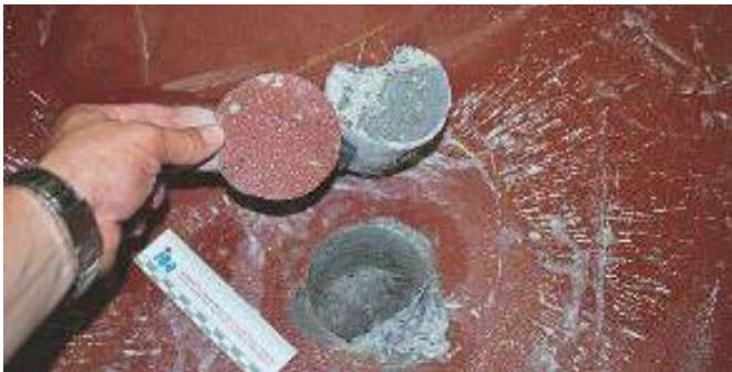
... bei Anbohren der Prüfstempel und Bohrkernentnahme
