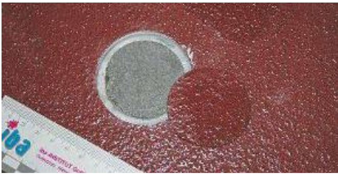
Ursachenforschung: Abscheren der Bodenbeschichtung...
