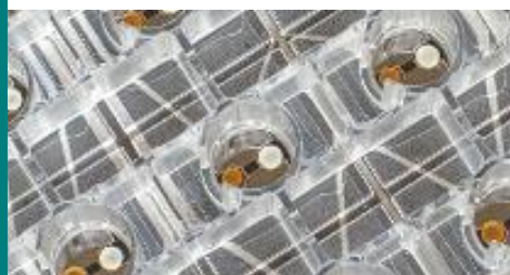
Detailansicht einer pCST-Multiwellplatte mit Reaktionskammern und Sensoren.
