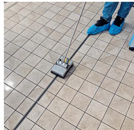
Mit diesem neuen Gerät, dem sogenannten Rinnenjet, lassen sich verbaute Schlitzrinnen einfach und effizient reinigen.
