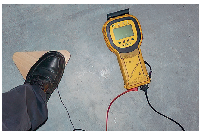
Messung mit der Dreifußelektrode.
