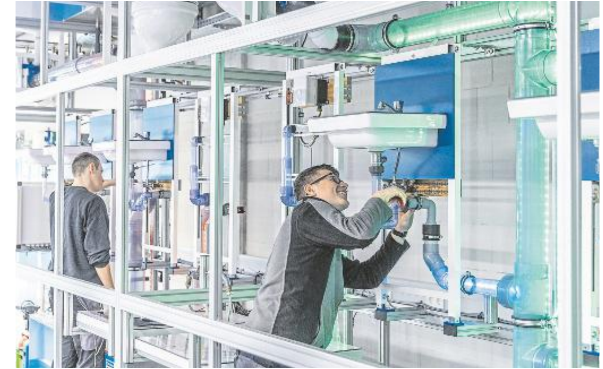
Die Abwasserhydraulikwand leuchtet grün, wenn alles richtig angeschlossen ist.
