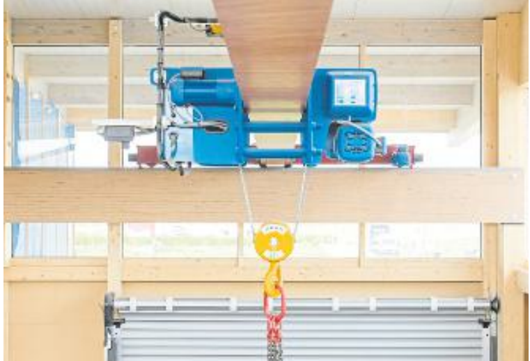
In der Zimmerei Hänslers läuft der Kran mit einer Hublast von 3,2 Tonnen auf 36 Meter langen Trägern aus Baubuche. Foto: Felix Schell
