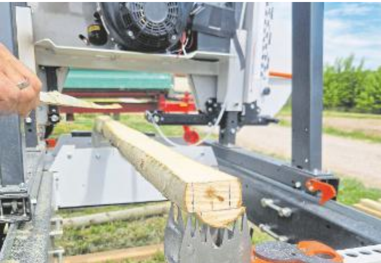
Mit einer mobilen Bandsäge wurden aus den Pappelstämmen Stäbe in Dachlattendimensionen geschnitten. Foto: HFR/Schöller
