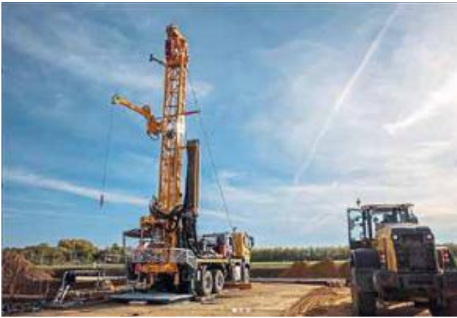
Die größten Hingucker bei Hoellscher Wasserbau befinden sich im Fuhr- und Maschinenpark. Oben: das neue Bohrgerät Bauer RB65, unten: die selbst gebaute Kabine für die RB65. Rechts: der Volvo FH16 mit 560 PS.
