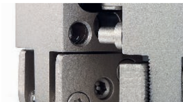
Die in das verdeckt liegende Band Pivota DXS 300 Steel Safe von Basys integrierte Bandseitensicherung verhindert, dass sich der Türflügel horizontal oder vertikal verschieben lässt. Dabei greift ein gehärteter Stahlstift auf der Zargenseite in eine Bohrung mit Kragen auf der Gegenseite.
