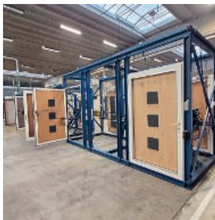
Im hauseigenen Prüflabor führt Sobinco mehr als 800 Tests pro Jahr durch. So werden etwa Türscharniere standardmäßig mit bis zu 1.000.000 Zyklen getestet.
