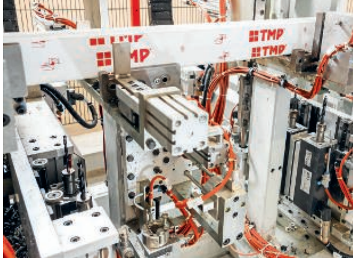
Der Einsatz eines zusätzlichen Schraub- und eines zusätzlichen vertikalen Bohr aggregates (Foto) erlaubt das gleichzeitige Bohren und Verschrauben der Stahlarmerung mit dem PVC-Profil.
