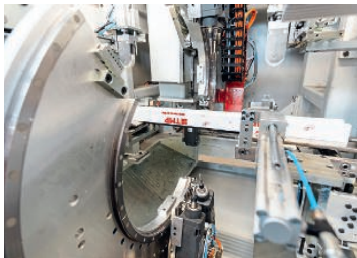
Das Acht-Achs-Orbit-Modul ermöglicht die Rundum-Bearbeitung des Profils in freier Lage.
