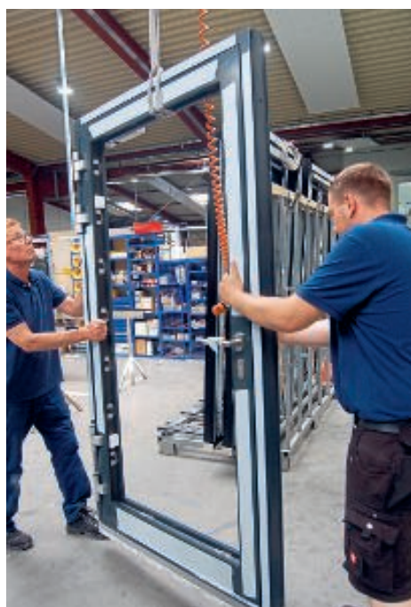
Mit der Aluminium-Außentür in EI290 Sa/S200C5 schließt Foppe+Foppe eine Lücke und bietet dem Markt eine hoch leistungsfähige Brandschutztür in Rohrrahmenbauweise.
