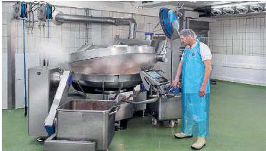
Das im CM 360 gekutterte und gekochte Fleisch für die Kalbsleberwurst kommt dank Wasserkühlung der doppelwandigen Schüssel schnell auf die richtige Temperatur für die Zugabe der Leber, die schon in der hydraulischen Beladung bereitsteht. K+G Wetter
