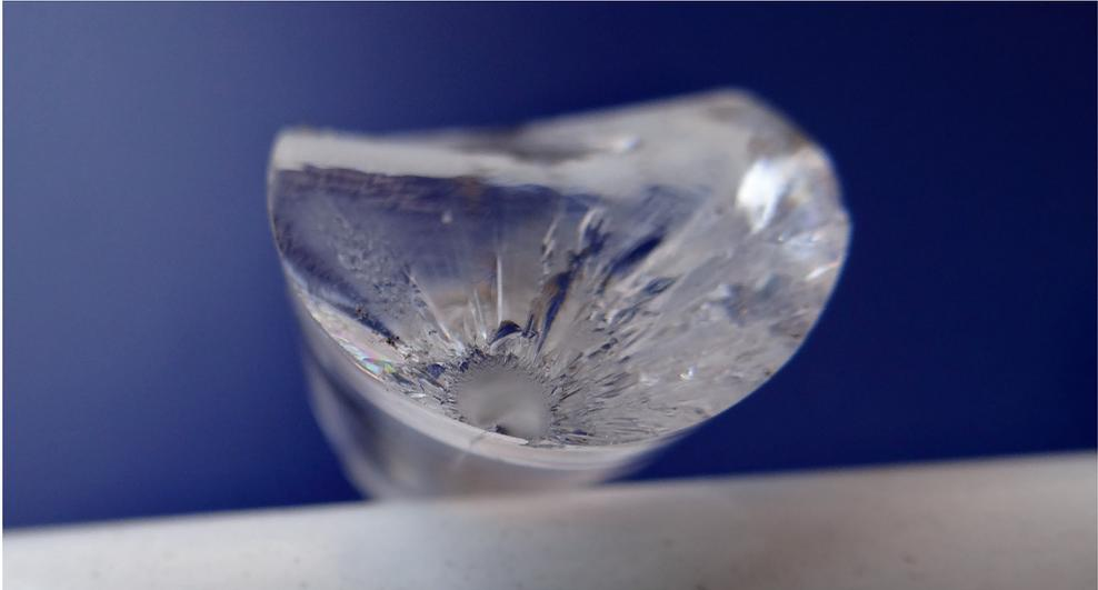
Abb. 3.14: Mechanischer Bruch an Glasstab ( $d= 20\text{ mm}$ ) mit relativ großem Bruchspiegel und erkennbarer Diskontinuität, vor der aus sich der Bruchspiegel gebildet hat.
