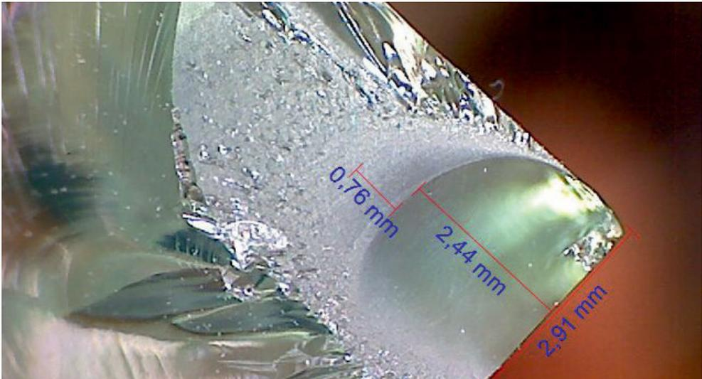
Abb. 3.8: Mechanischer Bruch an 19-mm-Floatglas mit deutlich erkennbarem, großem Bruchspiegel und großer Diskontinuität direkt im Eckbereich, von der dieser Bruch ausging.
