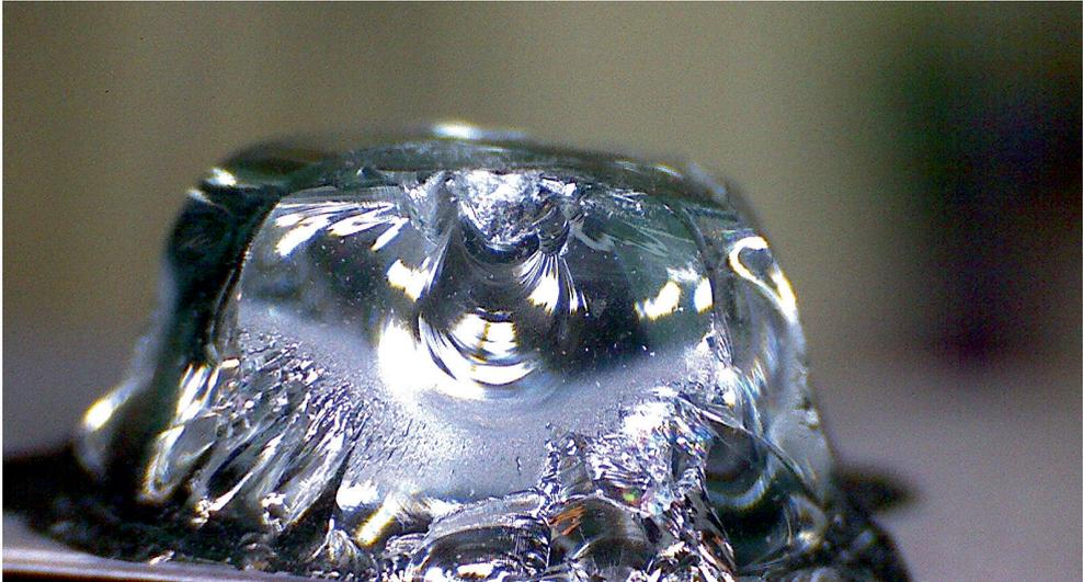
Abb. 3.10: Flacher, nur noch teilweise vorhandener Bruchspiegel an 6-mm-ESG durch mechanische Zerstörung (spitzer Schlag) verursacht. Anschlagstelle durch leichte Krümelbildung oben mittig am Bruchstück erkennbar, 20-fache Vergrößerung.
