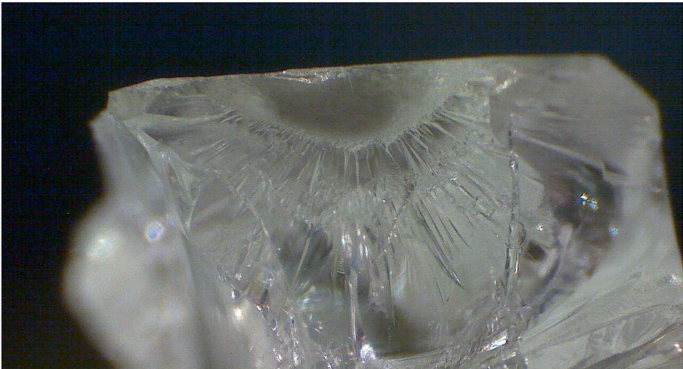
Abb. 3.9: 3-mm-ESG, Biegebruch, flacher ovalisierter Oberflächen-Bruchspiegel, da die Oberfläche unter Druckspannung steht (nachfolgend beschrieben), 20-fache Vergrößerung.
