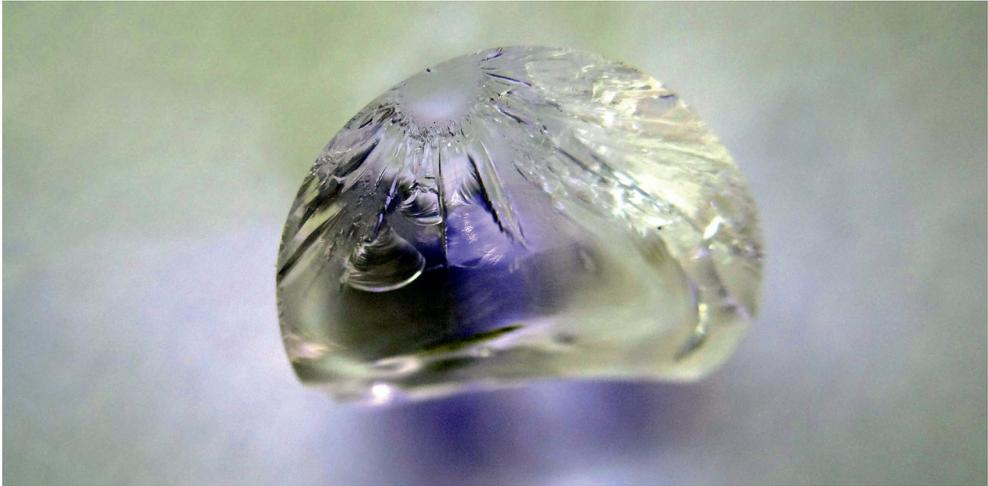
Abb. 3.16: Bruchspiegel eines Glasstabs. Erkennbare Diskontinuität, von der der Initialbruch ausgeht mit Rauzone und Lanzettbrüchen.
